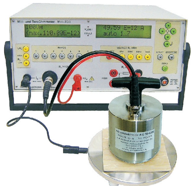
Messung des Oberflächenwiderstandes mit der AE 30-DIN und geerdeter Grundplatte GP 14 (optional) am Milli-TO 3
