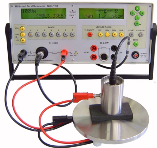
Messung des Oberflächenwiderstandes mit der Grundplatte GP14 (optional) und dem Milli-TO 3 (optional)
