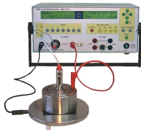
Messung Oberflächenwiderstand mit Grundplatte GP 14
