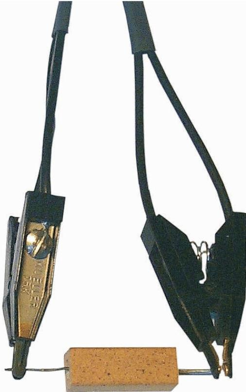
Die Kelvinzange KEZ-Mini 1 ist ein Vierpol-Zangenpaar zur Messung von kleinen Widerständen an Proben mit geringen Abmessungen.
